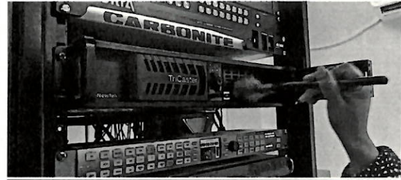
Remoción de polvo a la electrónica del sistema "3 Play"
