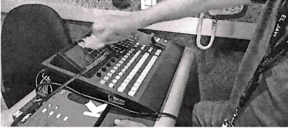
Limpeza en seco de mezcladora de video
