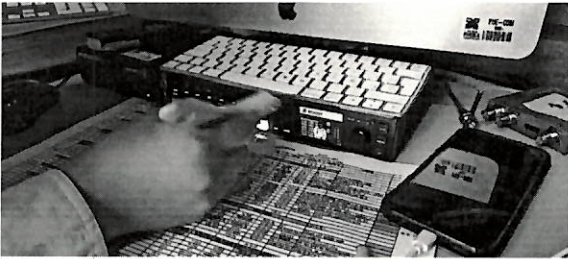
Limpeza en seco de la mezcladora de video
