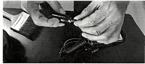
Chequeo de soldaduras a conectores de micrófonos lavaliere
